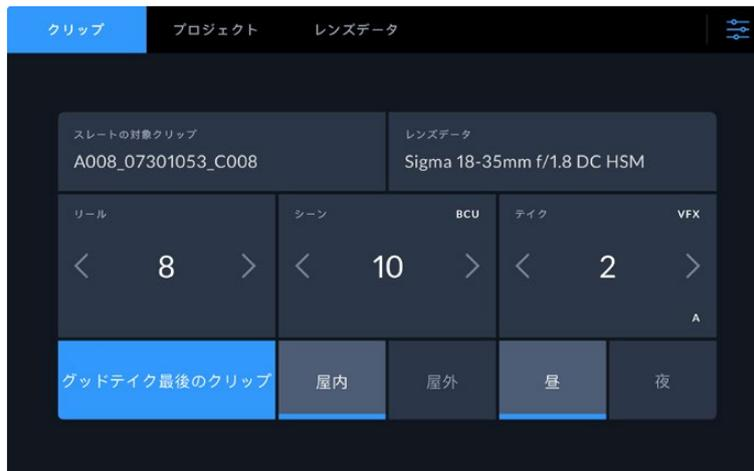
Video Assistが再生モードの場合、「スレートの対象クリップ」にはスレートが適用されるクリップが表示され、「グッドテイク」ボタンが表示されます。スタンバイモードの場合、「スレートの対象クリップ」は次のクリップになり、「グッドテイク - 最後のクリップ」ボタンが表示されます。
