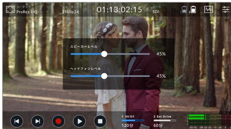
5インチモデルのVideo Assistではスピーカーおよびヘッドフォンのレベルを調整可能
