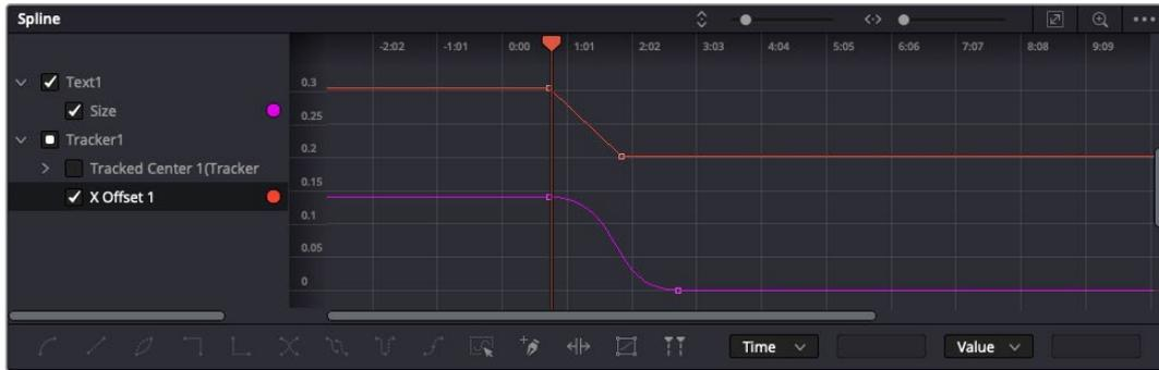
この写真では「Size」キーフレームアニメーションがベジェカーブで滑らかな曲線を描いています。ベジェハンドルをクリックしてカーブを長く/短くできます。またキーフレームの四角のアイコンをクリックして、キーフレームの場所を移動できます。
