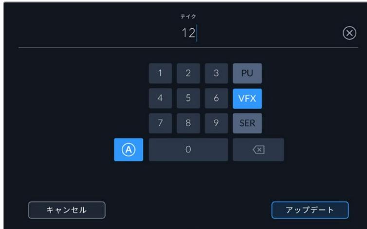
スタンバイモードで「A」をタップして、自動テイク番号増加の機能を有効にします。これで、クリップを収録するごとにテイク番号が足されていきます。自動テイク番号増加が有効になっている場合、スレートのテイク番号の隣に小さく「A」と表示されます。「テイク」メタデータを入力すると、タッチキーボードの右側に追加のショットタイプのプロンプトが表示されます。
