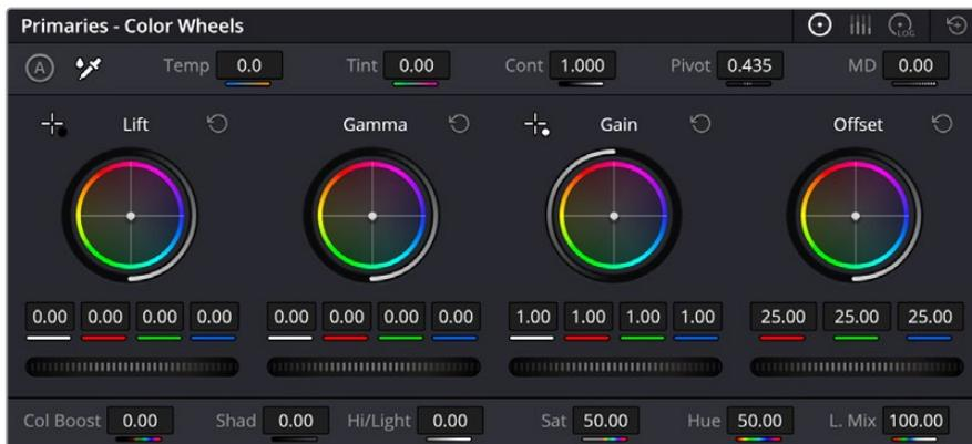
「リフト」、「ガンマ」、「ゲイン」、「オフセット」のカラーホイールで、クリップのカラーおよびトーンのバランスを完全にコントロールできます。各トーン領域のすべてのカラーに同じ調整を加えたい場合は、各カラーホイールの下のダイヤルを左右にドラッグします。
