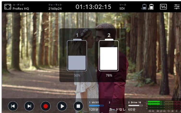
操作中、Video Assistは残量が少ない方のバッテリーを先に使用し、次にもう一方のバッテリーに間断なく切り替えます。バッテリー残量が25%以下になるとバッテリーアイコンが赤くなります。
